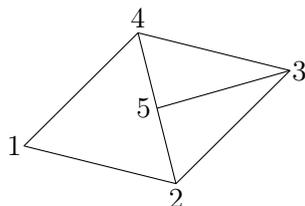
Auf dem Netz betrachten wir eine Diskretisierung der Bilinearform  $a(\cdot, \cdot)$  und der rechten Seite  $\ell(\cdot)$  mit stetigen, stückweise linearen Finiten Elementen. Folglich ist der Funktionswert am Knoten 5 als Durchschnitt der Funktionswerte der Knoten 2 und 4 gegeben. Stellen Sie das lineare  $(5 \times 5)$ -Gleichungssystem der Finite-Elemente-Diskretisierung auf, und formen Sie es in ein äquivalentes  $(4 \times 4)$ -Gleichungssystem um.
