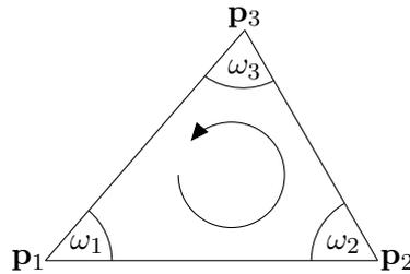
Zur Diskretisierung des Poisson-Problems mittels linearer finiter Elemente wird die Systemmatrix aus den *lokalen Elementmatrizen* zusammengesetzt. Die lokale Elementmatrix  $\mathbf{A}_T$  für das Dreieck  $T$ , gegeben durch die Eckpunkte  $\mathbf{p}_1 = (x_1, y_1)$ ,  $\mathbf{p}_2 = (x_2, y_2)$  und  $\mathbf{p}_3 = (x_3, y_3)$ , ist gegeben durch:
